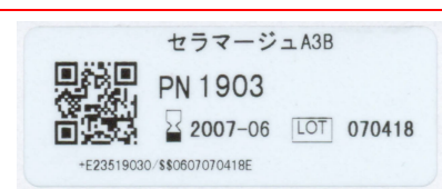
+E23519030/ Bild 3: Beispiel eines geschützten Codes: Das Datenelement beginnt mit dem Systemidentifikator „+“ der dies eindeutig als HIBC-Code ausweist.
