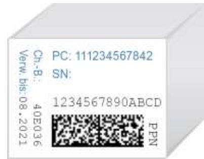
Bild 19) Pharma Product Number (PPN) codiert in DIN 16587 DMRE
