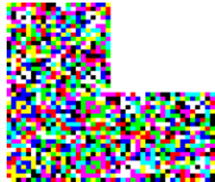
Bild 12) JAB-Code, bestehend aus Master-Symbol und 2 Slave-Symbolen
